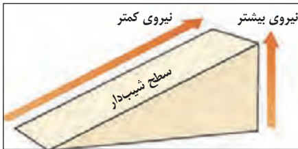
تأثیرگذاری سطوح شیب‌دار از آن جهت است که مسافت را افزایش می‌دهند و با افزایش مسافت، نیرو کاهش می‌یابد.
