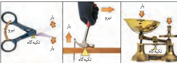
اهرم‌های نوع ۱ شبیه قیچی هستند، به این ترتیب که تکیه‌گاه جایی در میانه اهرم قرار دارد.
