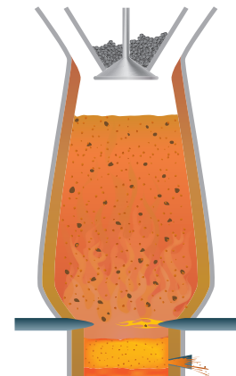
(ب) گرما دادن مخلوط سنگ آهن، کربن و سنگ آهک در کوره (ت) تولید ورقه‌های فلز آهن
