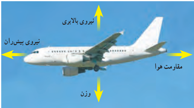
شکل ۶ - وقتی نیروهای وارد بر هواپیمای در حال پرواز متوازن باشند، تغییری در حرکت هواپیما ایجاد نمی‌شود.
