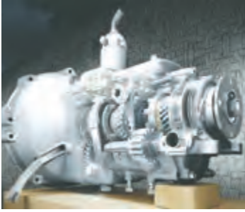
شکل ۱۵ - ترکیب پیچیده‌ای از چرخ‌دنده در جعبه‌دنده خودرو
