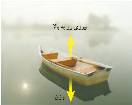
شکل ۵ - برای قایقی که ساکن روی آب است، نیروی رو به بالایی که به قایق وارد می‌شود هم اندازه با وزن قایق است.
