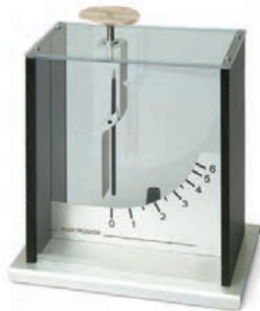
الف) تصویری از یک الکتروسکوپ در چه بندی شده بدون بار
