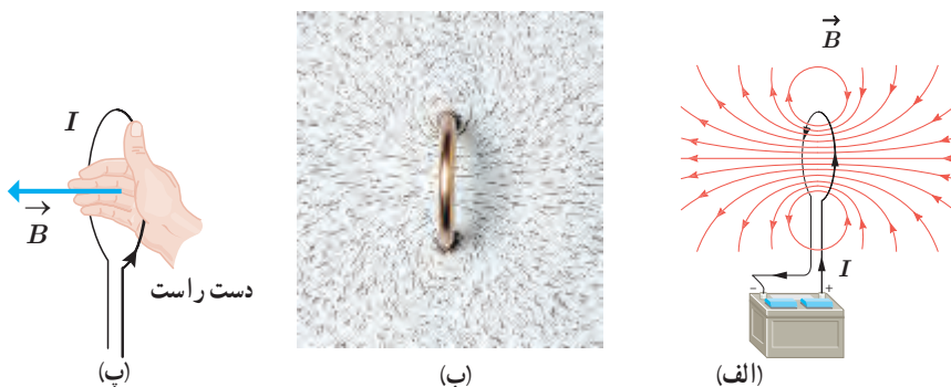
شکل ۳-۱۷ الف) خط‌های میدان مغناطیسی در اطراف یک حلقه حامل جریان. ب) طرح خط‌های میدان مغناطیسی یک حلقه حامل جریان با استفاده از برآه آهن. پ) استفاده از قاعده دست راست برای تعیین جهت \vec{B} یک حلقه حامل جریان.
