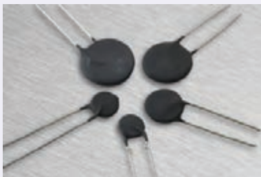
(ب) تصویری از چند ترمیستور دیسکی واقعی
