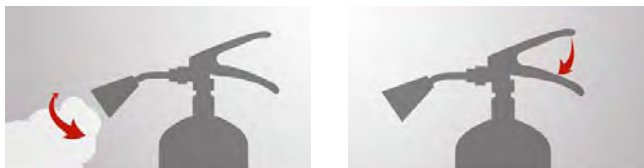
۴. اسیری کردن حریق با روش جاروب با فاصله حدود ۳ متر از آتش
