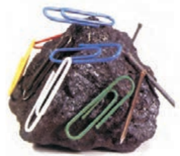
شکل ۱-۳ سنگ آهنربای طبیعی. تالس که اغلب از او به عنوان پدر علم یونان یاد می‌شود، ماده کانی مگنتیت Fe_3O_4 را که ویژگی آهنربایی دارد می‌شناخت.
