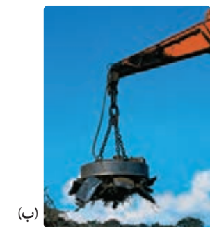
شکل ۳-۱۱ الف) سیملوله با هسته آهنی ب) آهنربای الکتریکی صنعتی
